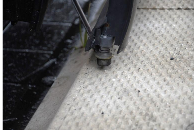
Aufsetzen der Türführung
